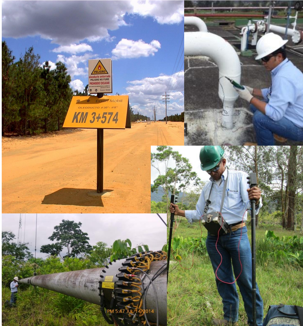
Figura 6: Fotocomposición con panorámica de recorrido del derecho de vía de ductos de transporte de hidrocarburos de Operadora Cerro Negro en Venezuela, durante actividades de inspección de sistemas de proyección catódica (superior izquierda), inspección de ductos e inspección DCVG (superior derecha e inferior derecha) e inspección por Onda Guiada en Ecuador (inferior izquierda).
