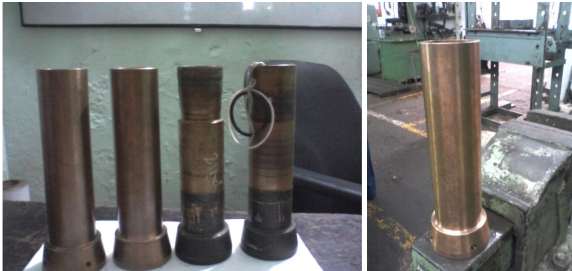
Figura 6. Fabricación de mangas en bronce SAE65 para bomba Gould P412
