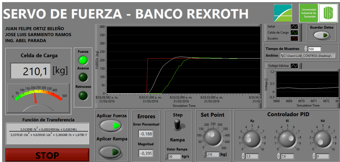
Figura 72. Respuesta en estado transitorio del control PID para una entrada escalón de 210 [kg]
