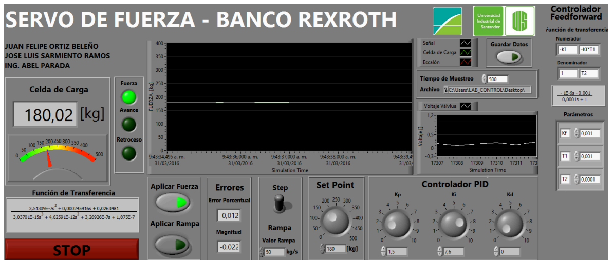
Figura 79. Respuesta del control PID con feedforward para setpoint de 180 [kg] y perturbación de 25 [kg].
