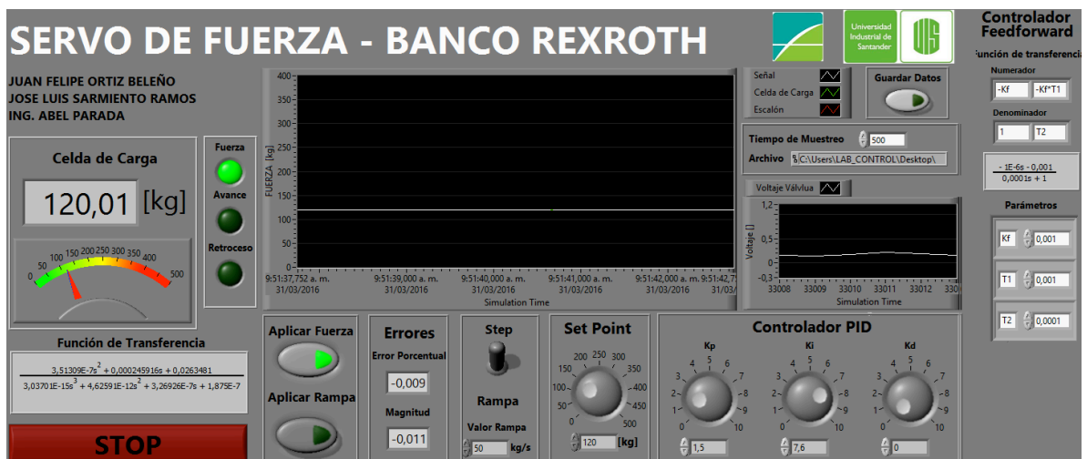
Figura 80. Respuesta del control PID feedforward para setpoint de 120 [kg] y perturbación de 25 [kg].
