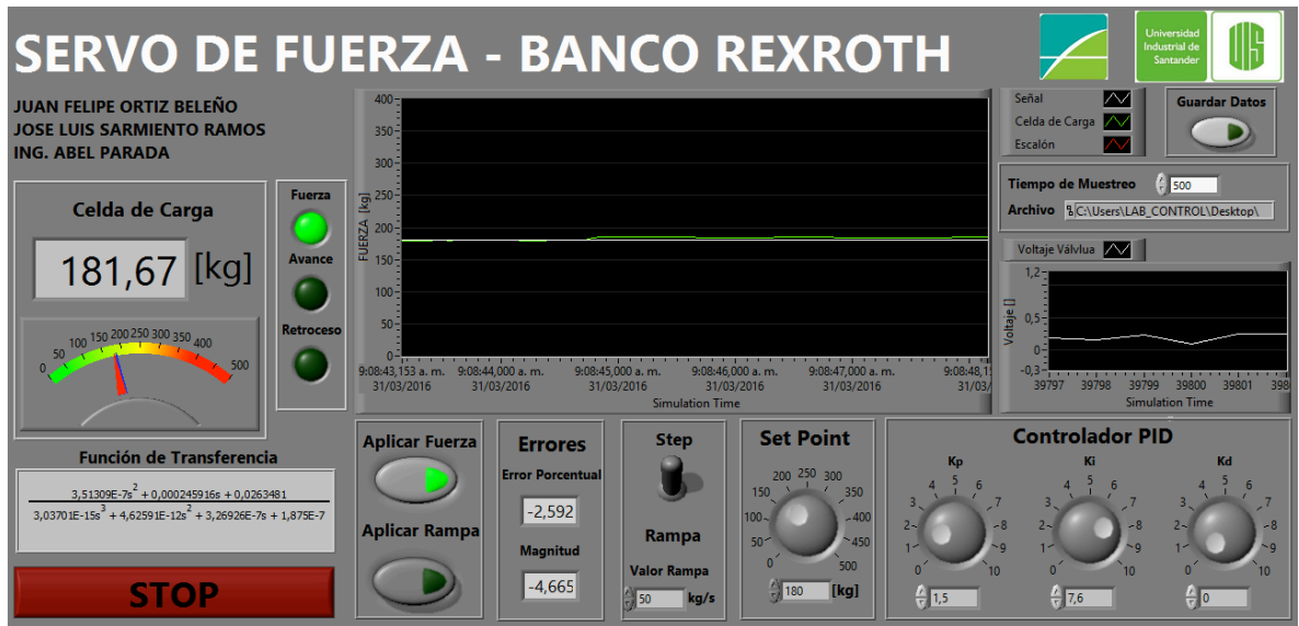
Figura 78. Respuesta del controlador PID ante una perturbación de 25 [kg].
