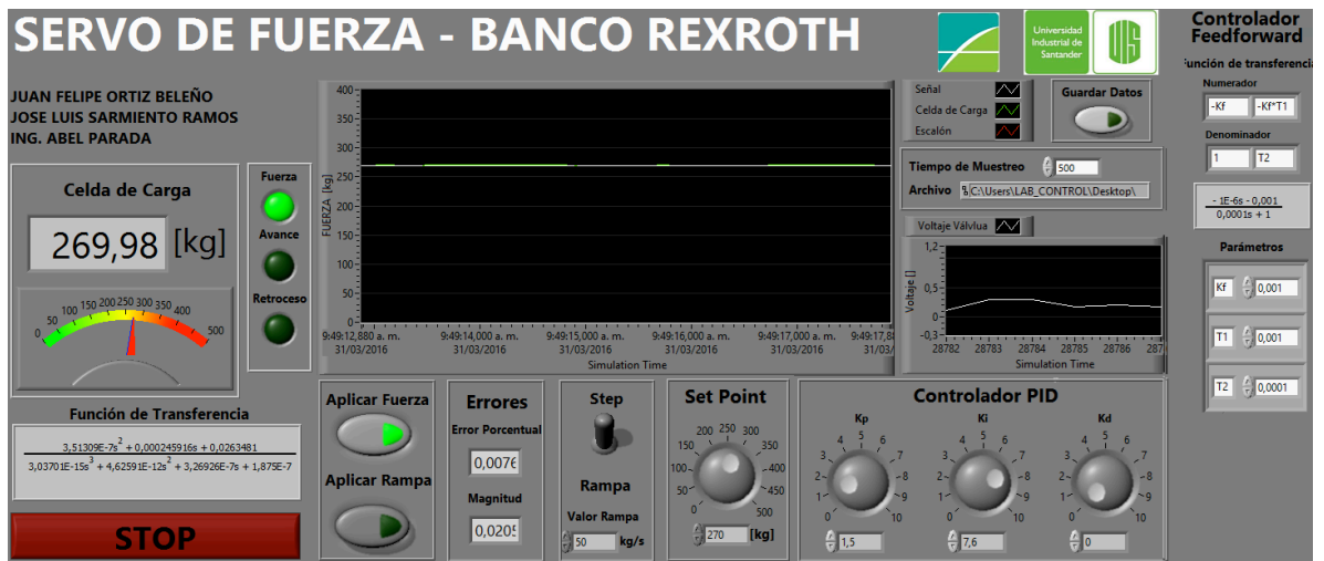
Figura 82. Respuesta del control PID con feedforward para setpoint de 270 [kg] y perturbación de 25 [kg].
