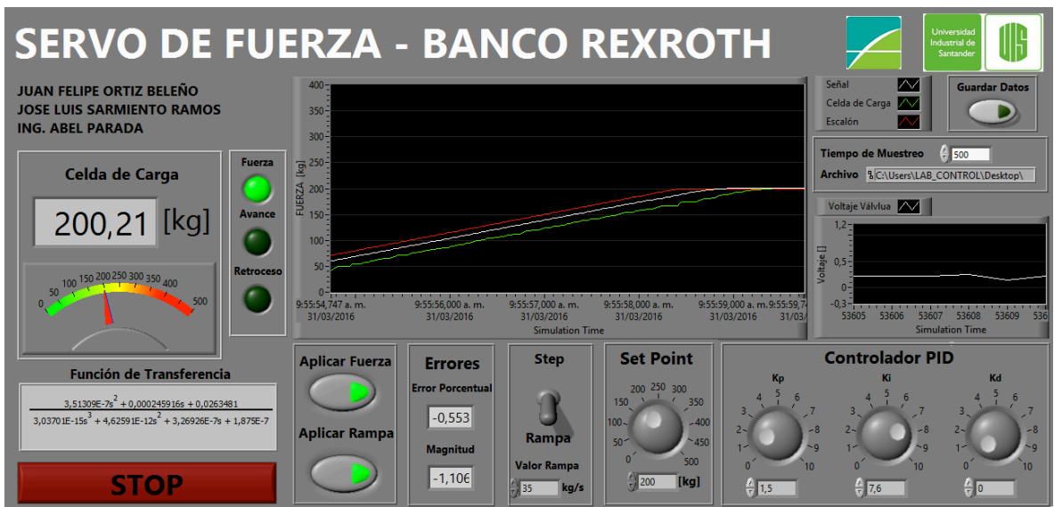
Figura 76. Respuesta para un setpoint de 200 [kg] con un valor de rampa de 25[kg/s].
