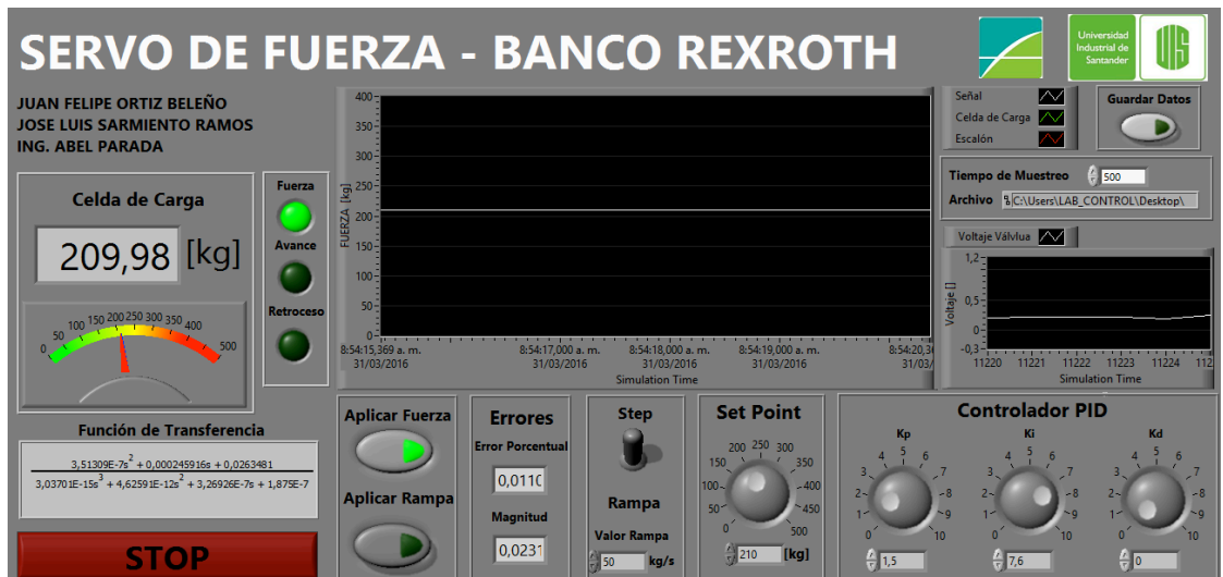
Figura 73. Respuesta en estado estacionario del control PID para una entrada al escalón de 210 [kg].
