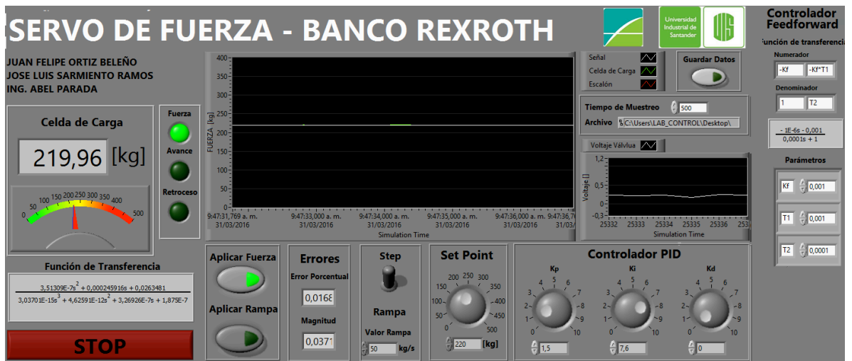
Figura 81. Respuesta del control PID con feedforward para setpoint de 220 [kg] y perturbación de 25 [kg].
