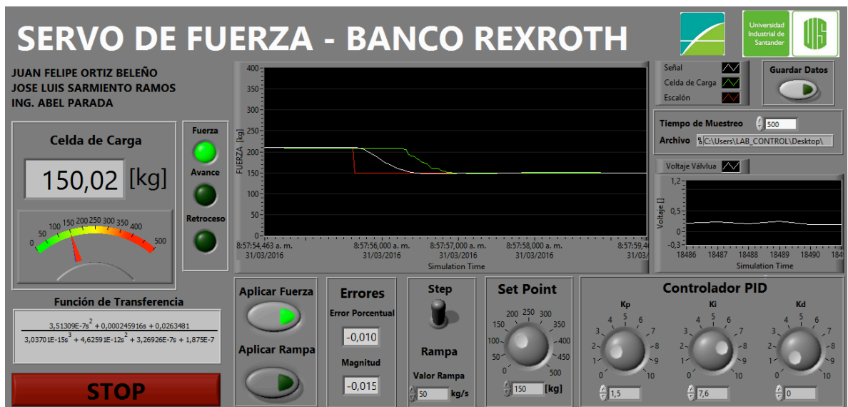
Figura 74. Respuesta del controlador PID para una variación en el setpoint de 210 [kg] a 150 [kg].
