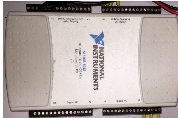
Figura 11. Tarjeta de adquisición de datos NI DAQ USB 6212.
