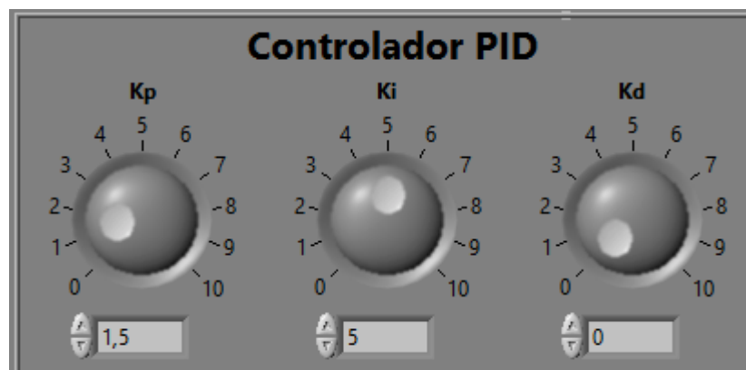
Figura 60. Sección de sintonización del controlador PID.
