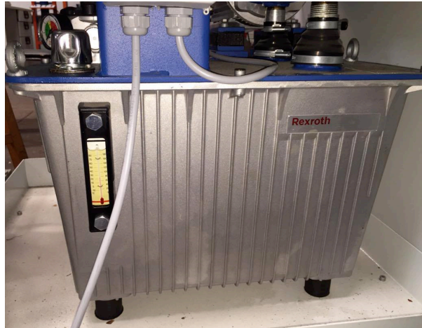
Figura 3. Tanque hidráulico Rexroth.
