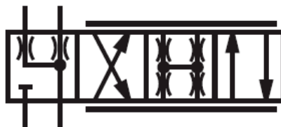
Figura 13. Posiciones de la válvula direccional proporcional Rexroth 4WRPEH6 C3 B04L - 20/G24K0/A1M.
