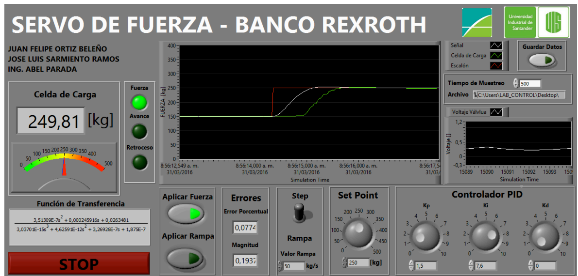
Figura 75. Respuesta del controlador PID para una variación en el setpoint de 150 [kg] a 250 [kg].
