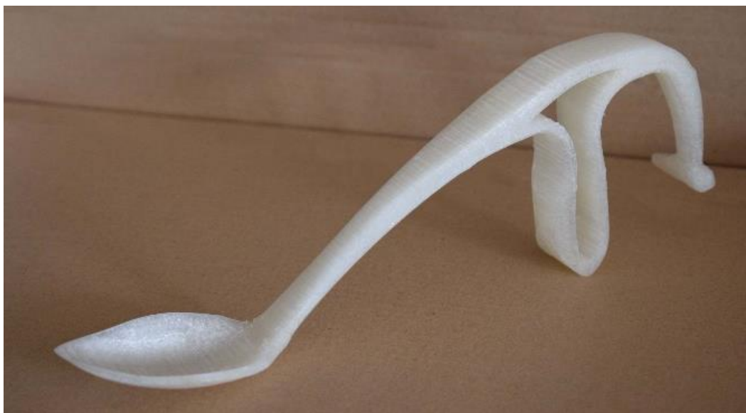
Figura 45. Vista perspectiva del utensilio real. Hecho en PLA soporta altas temperaturas y es biodegradable en caso de ser desechado.
