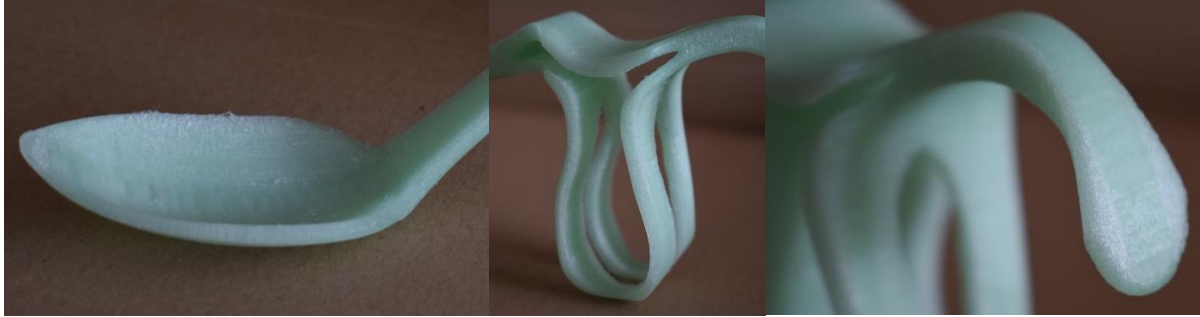
Figura 61. Detalles del modelo mejorado. Hecho en PLA resiste alta temperaturas y es biodegradable en caso de ser desechado.
