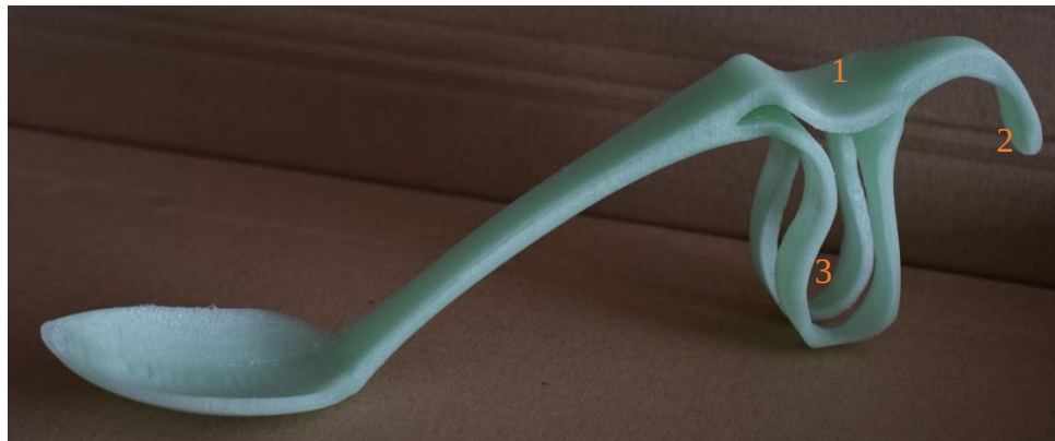
Figura 60. Cambios aplicados al modelo inicial. En la imagen se puede apreciar las tres mejoras realizadas con respecto al anterior: 1. Reducción el arco donde se apoya el dedo pulgar. 2. El recorte del soporte dorsal con un cambio en la forma. 3. Aumento de la circunferencia del soporte de la palma de la mano.
