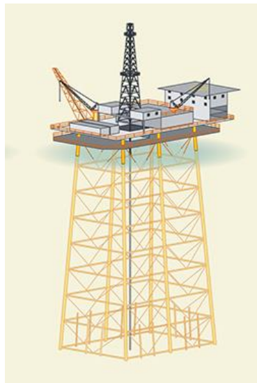
Figura 2. Sistema de posicionamiento por pilotes
