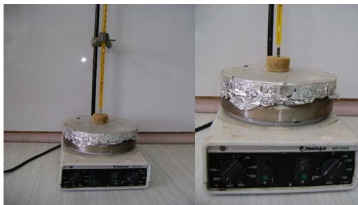
Figura 29: Montaje para determinar la conductividad térmica
