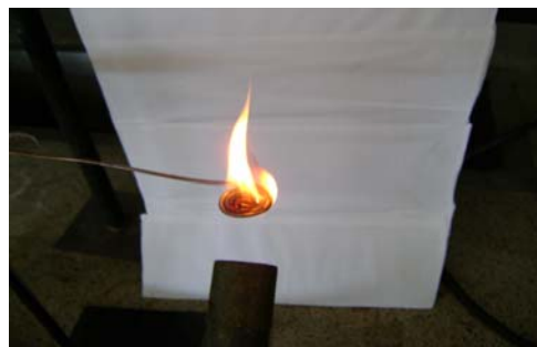
figura 12: Combustión de los cristales de ABS
