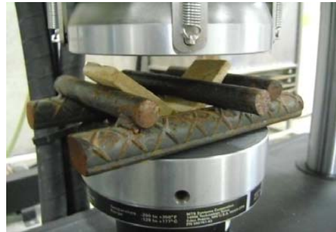
figura 28: Ensayo de flexión finalizado
