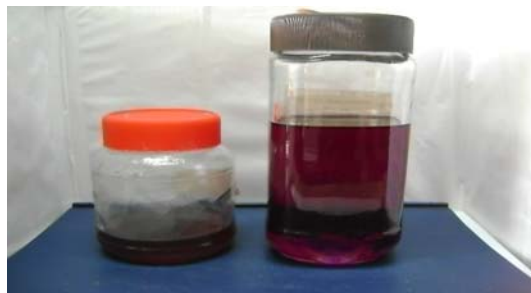
Figura 15: Izquierda solución (ABS + Resina), derecha solución resina preacelerada
