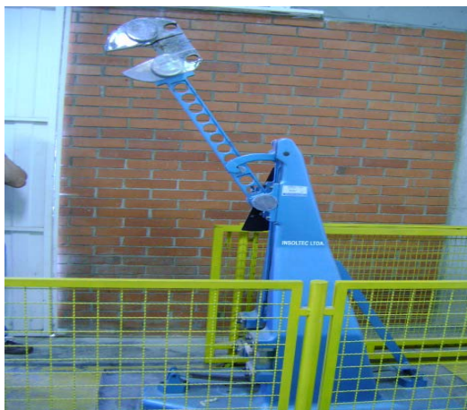
Figura 26: Equipo para ensayos de impacto
