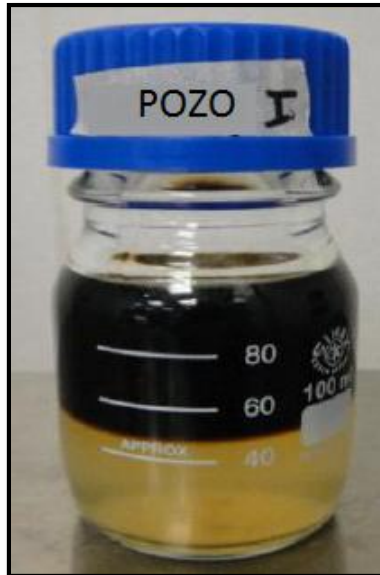
Figura 2. Prueba de emulsión y resolución de la mezcla agua – crudo del pozo 1.
