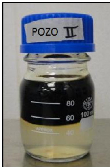
Figura 3. Prueba de emulsión y resolución de la mezcla agua – crudo del pozo 2.
