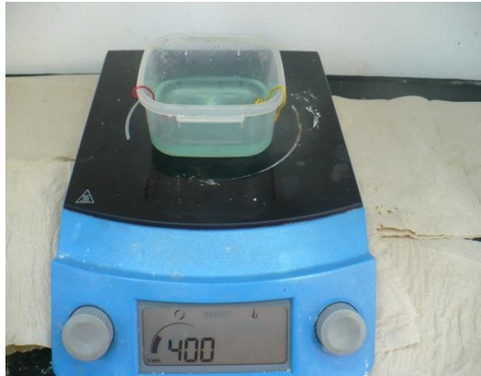
Figura 6. Proceso de pulido químico de la aleación Ti6Al4V.
