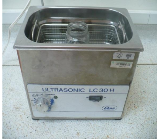
Figura 7. Fotografía del equipo de limpieza ultrasónica usado para la preparación de las muestras de Ti6Al4V.
