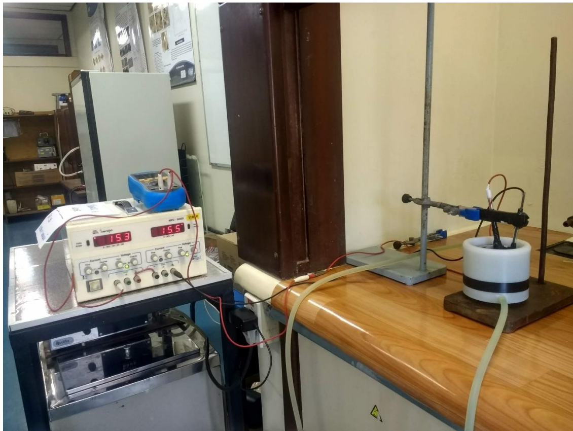
Vaso de precipitado con solución electrolítica, ánodo y cátodo conectado a la fuente de alimentación
