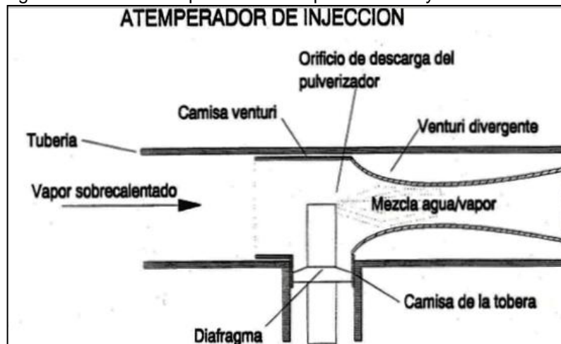
Figura 5. Partes Principales del Atemperador de Inyección.
