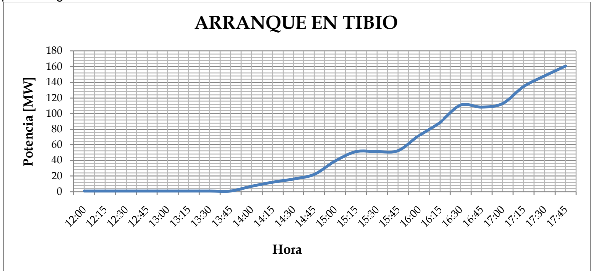
Figura 15. Histórico de la potencia generada desde la hora cero del arranque hasta Operación a plena carga.
