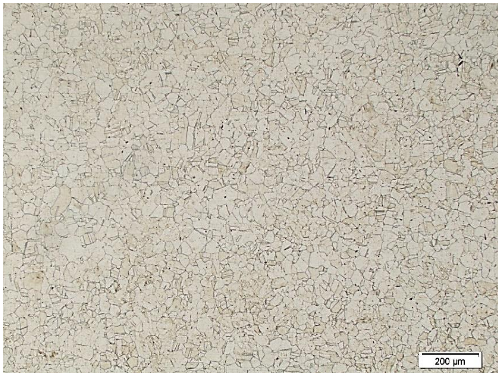
Figura 4. Micrografía del acero inoxidable 316L en su estado inicial tomada en un microscopio óptico OLYMPUS GX71F (100 aumentos)
