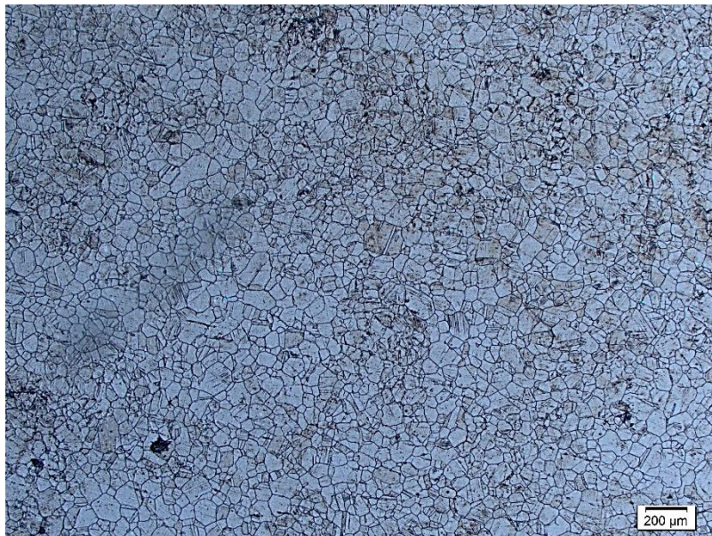
Figura 6. Micrografía del acero inoxidable 316L después de la exposición a 450 °C y 150 horas, tomada en un microscopio óptico OLYMPUS GX71F (100 aumentos).
