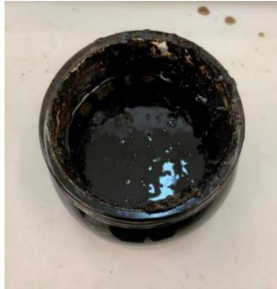
**Nota.** En la figura se puede evidencia como el crudo con depósitos de parafina pasa aun estado más fluido.
