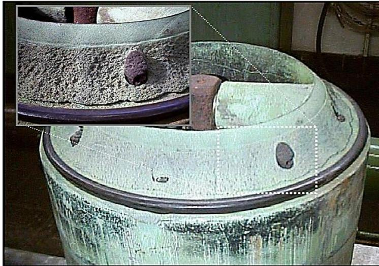
**Nota.** Efecto de cavitación en válvula anular por erosión en la carcasa del material. Fuente tomado de URALITA Sistemas de Tuberías, (2003).
