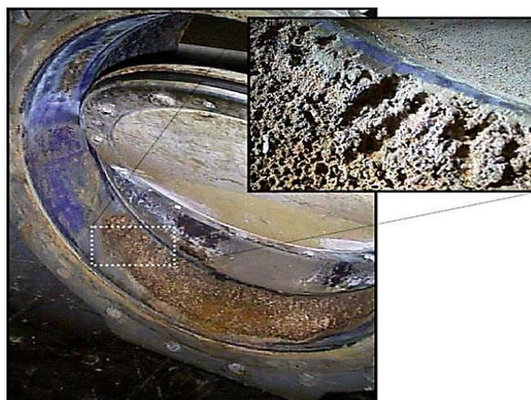
**Nota.** Efecto de cavitación en válvula de mariposa por vibraciones excesivas a tiempos prolongados.
