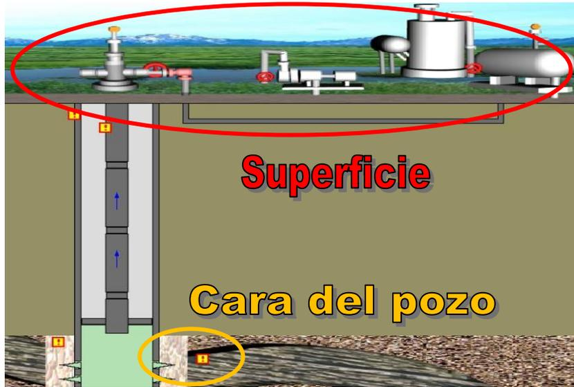
**Nota.** El esquema explica la división esquemática que hay en la aplicación de la técnica de inhibición de parafinas con ultrasonido. Modificado de Software PERFORM v7.53.
