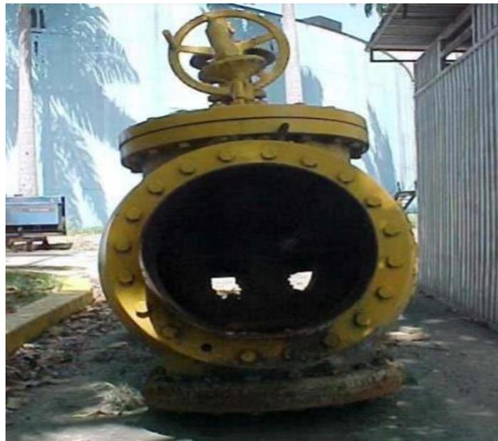
**Nota.** Efecto de cavitación en válvula de compuerta, se observan aperturas que dañaron la válvula totalmente. Fuente tomado de URALITA Sistemas de Tuberías, (2003)
