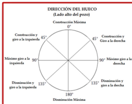
Figura 36: Regla del dedo gordo para determinar la orientación de la cara de la herramienta
