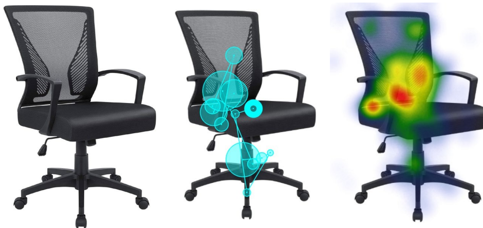
Figura 36 Representación gráfica del seguimiento ocular del primer estímulo A (interacción libre). De izquierda a derecha: A. modelo de silla sin interacción. B. Mapa de sacadas y fijaciones, donde los círculos más grandes indican las áreas con mayor tiempo de observación por parte de un único participante. C. Mapa de calor que refleja la suma total de interacciones visuales para toda la muestra, destacando las áreas con mayor atención acumulada.
