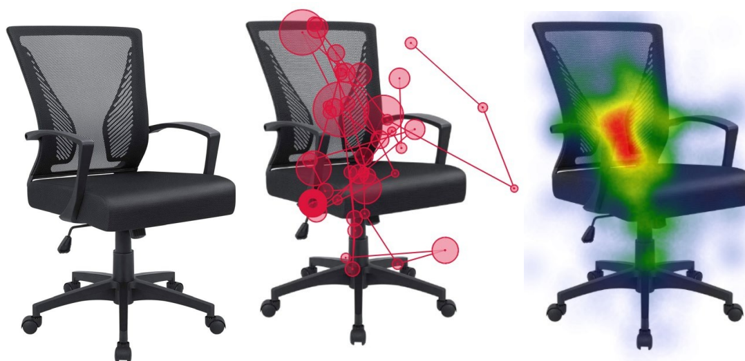
Figura 30 Representación gráfica del seguimiento ocular del primer estímulo A (comodidad). De izquierda a derecha: A. modelo de silla sin interacción. B. Mapa de sacadas y fijaciones, donde los círculos más grandes indican las áreas con mayor tiempo de observación por parte de un único participante. C. Mapa de calor que refleja la suma total de interacciones visuales para toda la muestra, destacando las áreas con mayor atención acumulada.
