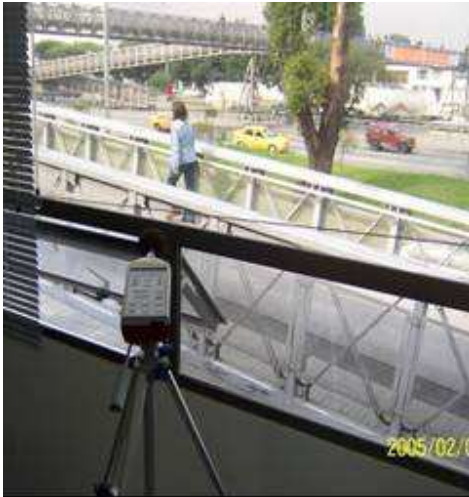
Figura 11. Monitoreo de ruido generado por un puente peatonal.
