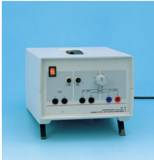
Figura C. 19. Transformador variable de baja tensión
