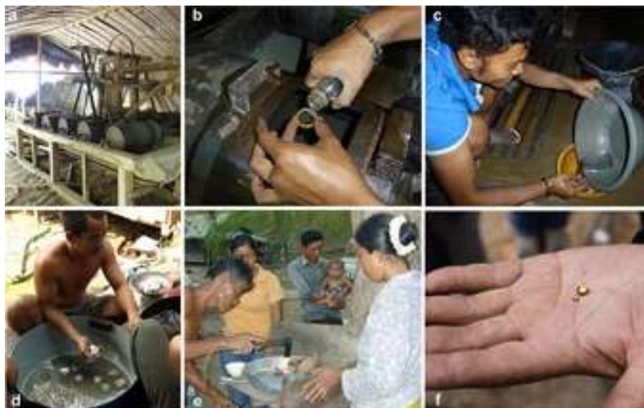
Figura 1. Método de amalgamación en la MAPE. A). Los molinos se usan para triturar las rocas que contienen el mineral. B). Se agrega entre 0.3 y 1 Kg de Hg por cada 20 Kg de mineral triturado. C). Las amalgamas de Hg y oro se separan manualmente de las rocas y arenas finamente trituradas. D). Las amalgamas se filtran con el fin de eliminar el exceso de Hg°. E). La amalgama Hg-oro se calienta para evaporar el Hg. F). Se obtiene el oro puro. Adaptado de Esdaile & Chalker (2018).
