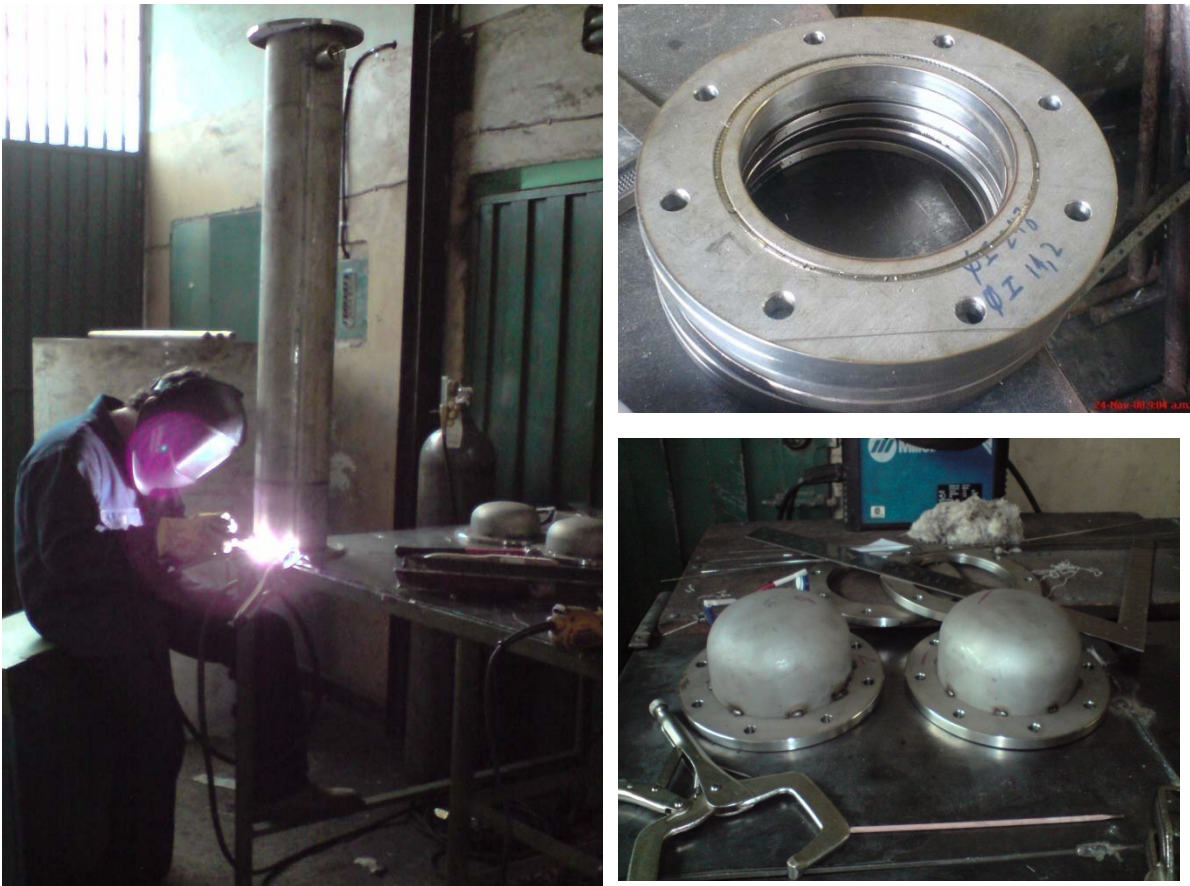
Figura 57. Proceso de soldadura de bridas y conexiones.
