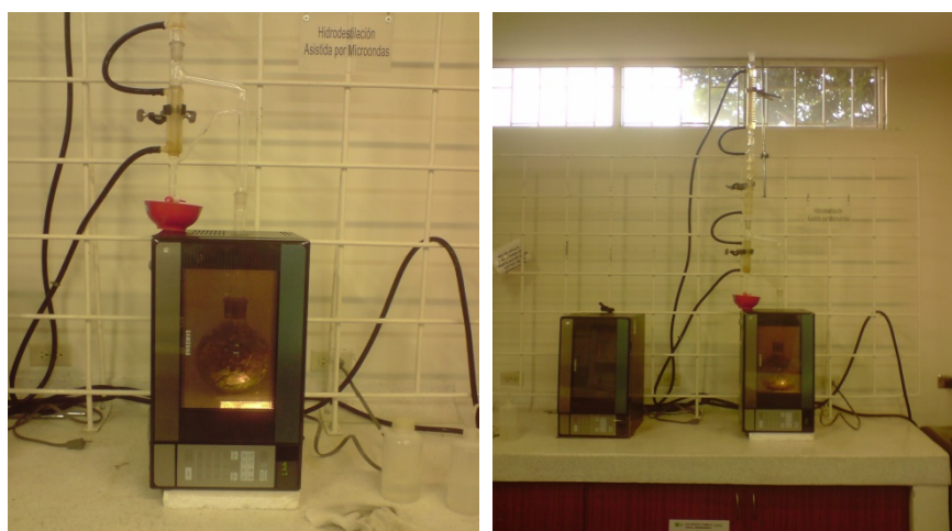
Figura 5. Extracción por la radiación de microondas, equipo de laboratorio.
