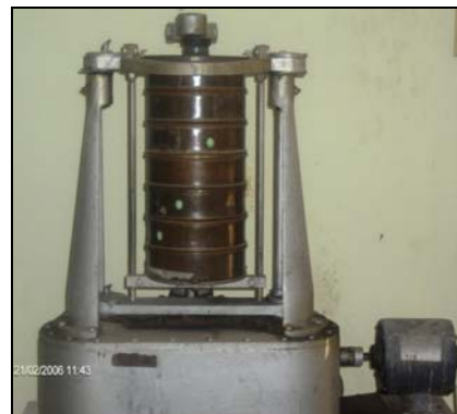
Figura 24. Agitador. Herramienta para realizar el tamizado
