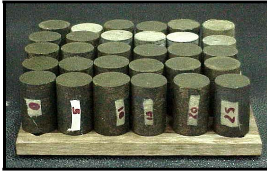
Figura. 28. Fotografía de los plugs sintéticos fabricados.
