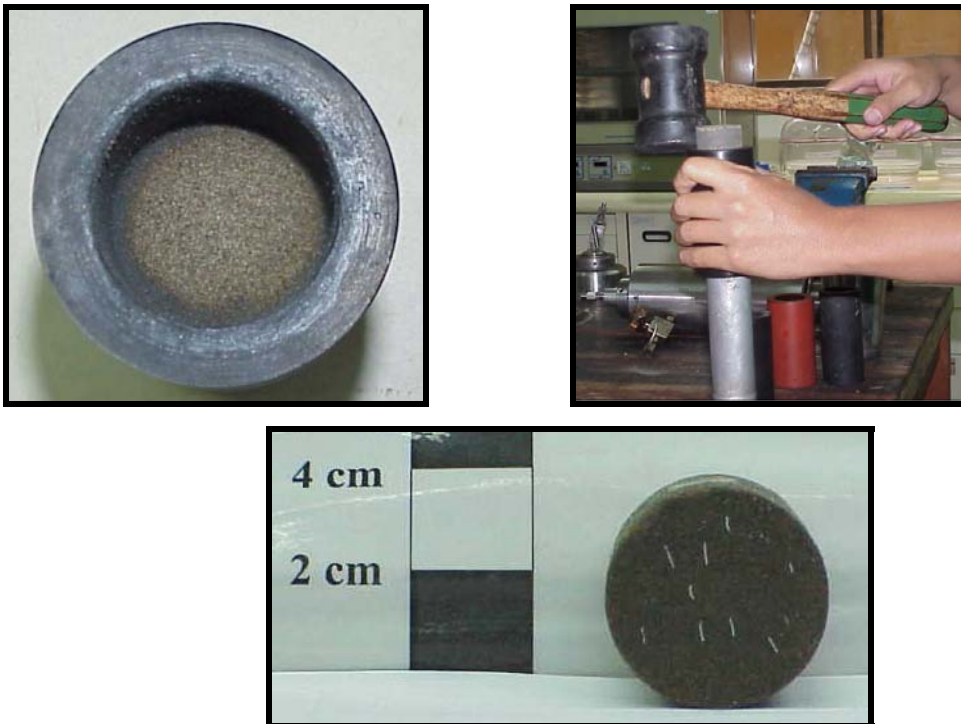
Fig. 26. Fabricación de modelos sintéticos de rocas con inclusiones de láminas de Aluminio simulando microfracturas
