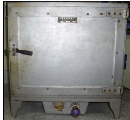
Figura 22. Horno para secado a 120°C.
