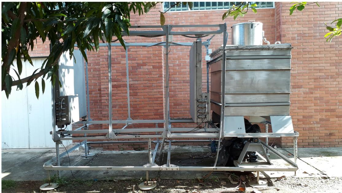
*Figura 180.* Estructura del detector MuTe. El WCD se sitúa en el centro de masa de la estructura facilitando la elevación angular (máx.  $15^\circ$ ). La distancia entre los paneles varía desde 40 cm a 250 cm.
