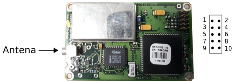
*Figura 127.* GPS Motorola Oncore. El puerto de comunicación contiene 10 pines en los cuales resaltan el PPS (6), transmisión (8) y recepción de datos (9), batería (1), alimentación (2) y tierra (3). La antena se conecta a un puerto tipo MCX.
