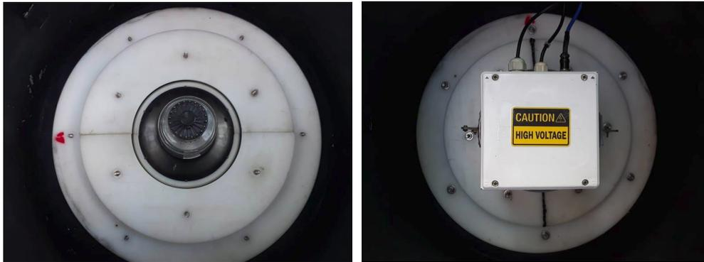
Figura 114. Montaje del PMT en el WCD de MuTe. El PMT se sujeta por dos anillos plásticos desmontables adheridos a la estructura del WCD con 12 tornillos y silicona. La electrónica de polarización se instala al interior de una caja plástica hermética: Dos cables RG58 (negro) transmiten las señales del PMT y un cable RJ45 (azul) recibe las señales de control y alimentación.
