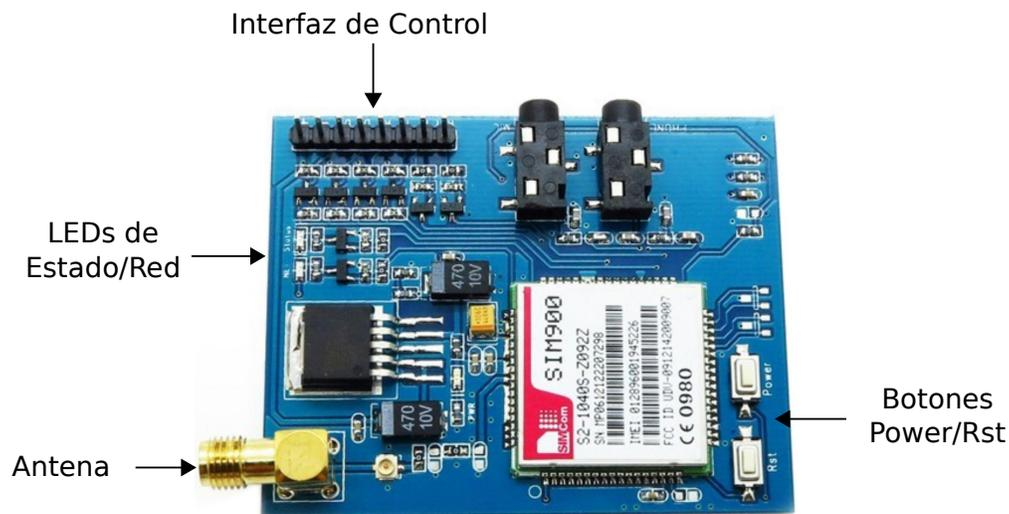
*Figura 152.* Módulo de comunicación GPRS/GSM ITEAD SIM900. Los LED Status y Network determinan el estado del módulo GSM (encendido/apagado) y de la conexión a la red (sin registro/registrado/conectado). La interfaz de control permite transmitir o recibir datos mediante comandos AT a través del protocolo serial.
