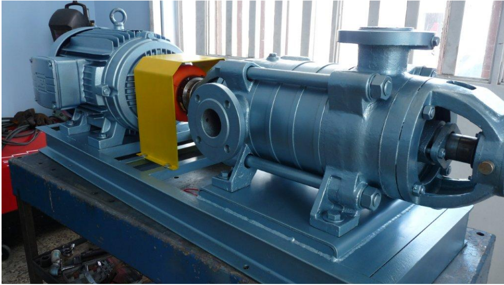
Figura 43. Ilustración montaje electrobombas alternadas de superficie horizontal.
