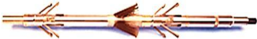
Figura 38. Presentación de un registro de calibración de 4 brazos
