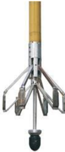
Figura 41. Herramienta con seis patines, Six-Arm Stratigraphic Dipmeter
