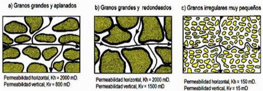
Figura 7. Efecto de la forma y tamaño de grano en la permeabilidad.
