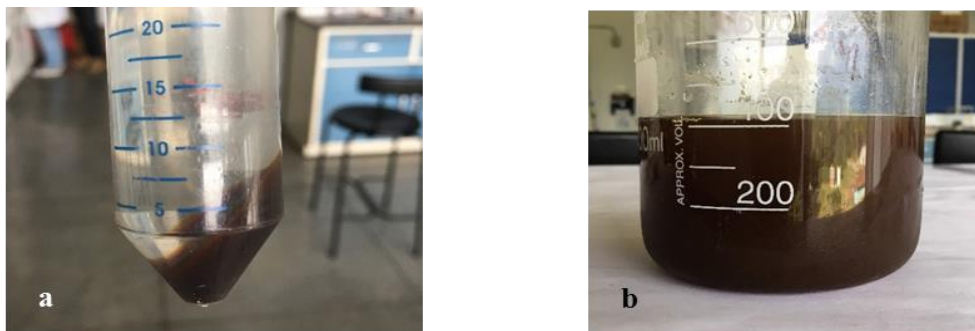
Figura 7. Óxido de grafeno. a) Precipitado con ausencia de iones en sobrenadante. b) Suspensión de óxido de grafeno.
