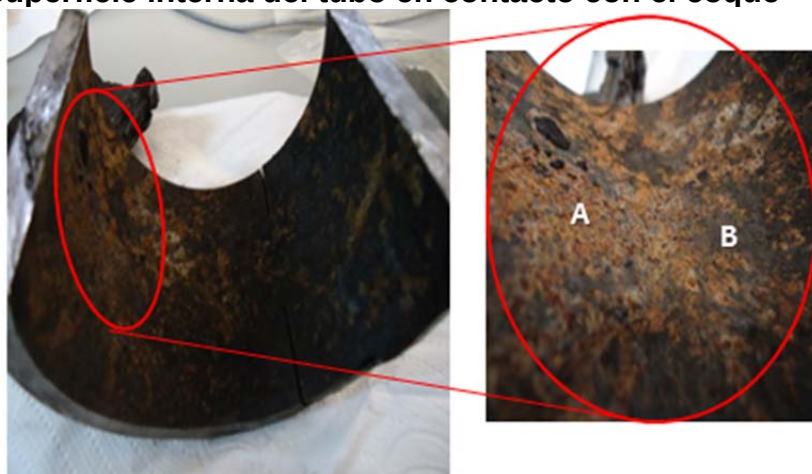
Figura 39. Superficie interna del tubo en contacto con el coque
