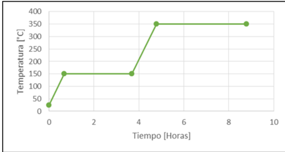
Figura 24. Ciclo de tratamiento térmico utilizado en la fase preparatoria
