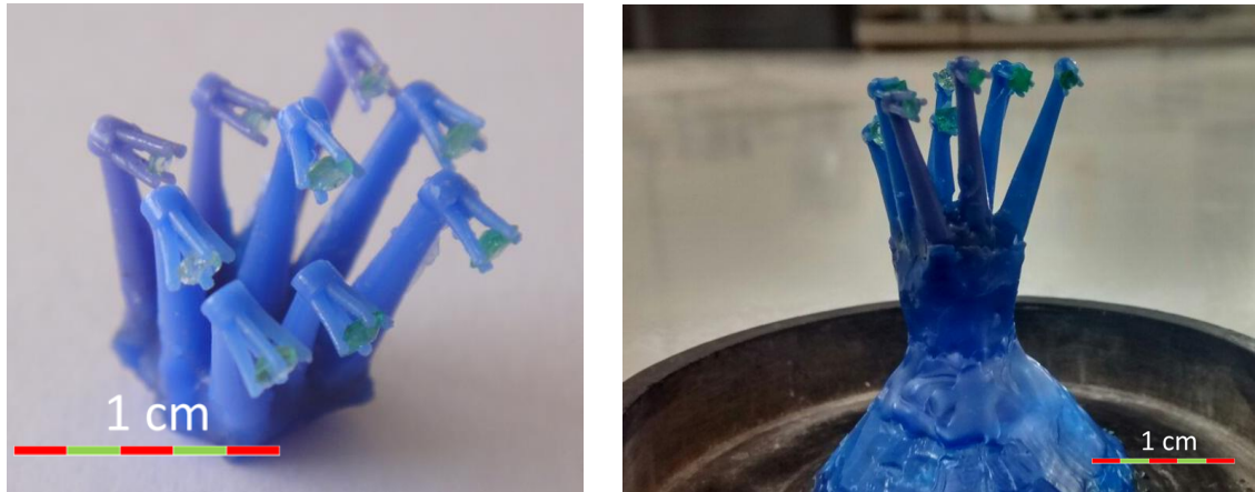
Figura 23 Conformado de las piezas pre engastadas en forma de acerico
