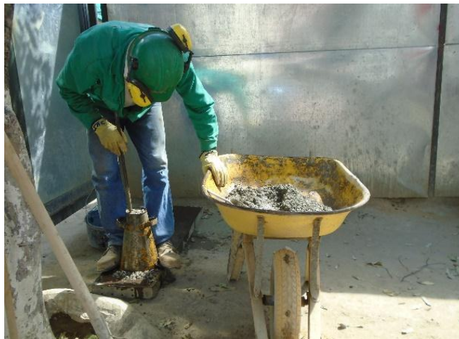
Figura 7. Prueba de asentamiento slump
