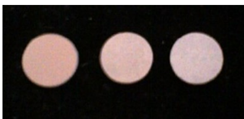
Fig. 3. Recubrimientos de \text{SiO}_2\text{-P}_2\text{O}_5\text{-Na}_2\text{O-CaO} obtenidos por la técnica APQ
