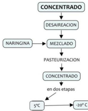
Figura 4: Proceso de concentrado.
