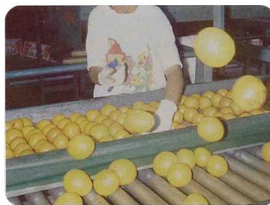
Figura 3: Inspección y control de la mandarina.
