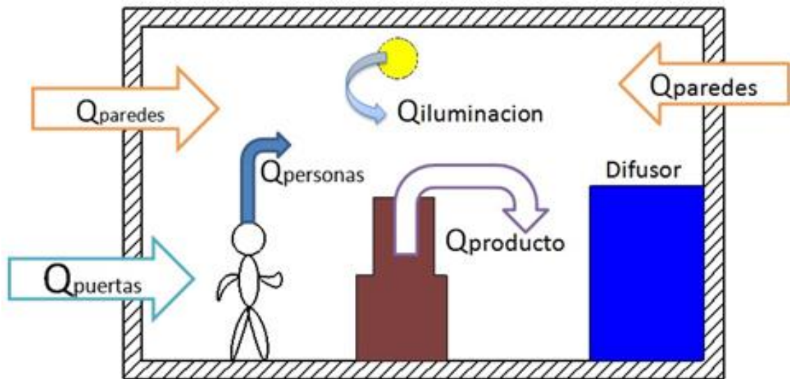
Figura 52: Ganancias de calor en el cuarto frío.
