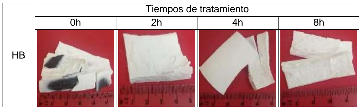
Figura 3. Muestras de hueso bovino (HB) después de la limpieza química con NaOH y tratadas térmicamente a diferentes tiempos.
