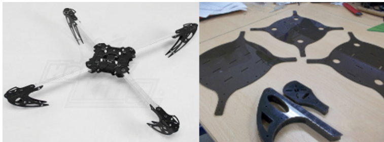
Figura 2.2: Estructura comercial y modificada. Fuente: http://www.hobbyking.com y autores.
