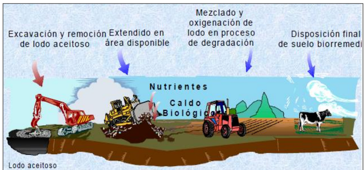
Figura 4. Biorremediación de lodos aceitosos
