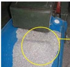
**MOLIENDA:** El polietileno se tritura en un molino, que proporciona un tamaño de grano apropiado para el proceso posterior de maquinado.
