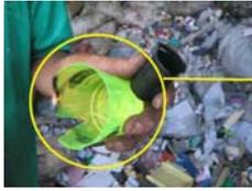
**PRUEBAS FÍSICAS:** La comprobación por medio de pruebas como el comportamiento a la flama y la resistencia a la compresión, proporcionan mayor seguridad de que el elemento reciclable es del polímero esperado.
