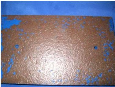
Se llevó a cabo el proceso de recolección, limpieza y molienda de envases elaborados con este material, la granza fue elevada a su temperatura de transición vítrea (150°C), observándose que el PEAD, presenta un comportamiento estable frente a las condiciones de temperatura, ofrece excelente maquinabilidad y sus propiedades se mantienen después de haber llevado a cabo el reciclaje.
