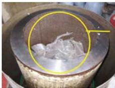
**SECADO:** La carga es sometida a un proceso de centrifugado en donde se extrae completamente la humedad.
