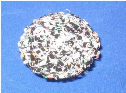
Se recolectaron 5 kilos de bolsas de leche a los que se les aplicó primeramente un proceso de limpieza. El material fue picado y se sometió a una temperatura de 150° C. Del comportamiento de las probetas obtenidas se concluyó que la densidad del polímero no es lo suficientemente alta para ofrecer un producto con la rigidez que requiere el sistema.
