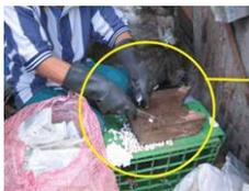
**LIMPIEZA:** Se extraen elementos metálicos que pueden causar contaminación en el proceso. Igualmente se eliminan las etiquetas por medio de herramientas cortopunzantes que permiten el raspado del papel.
