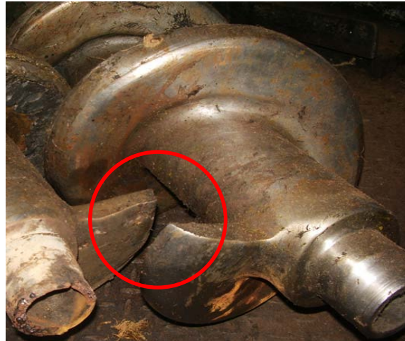
Figura 60. Área crítica de desgaste en los tornillos de prensado
