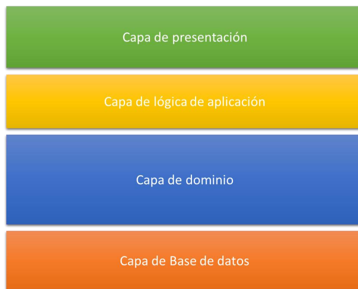
Figura 17: Patrón de arquitectura de cuatro capas
