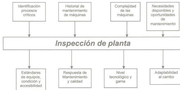
Gráfica 10. Procedimiento de Inspección de planta y activos
