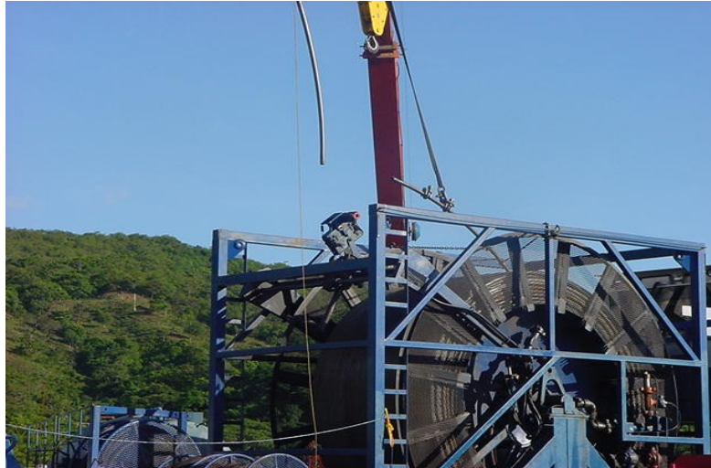
FIGURA 41. Foto de la falla en el pozo # 67, en la cual la sarta se rompió en dos entre el levelwind y el horse power.
