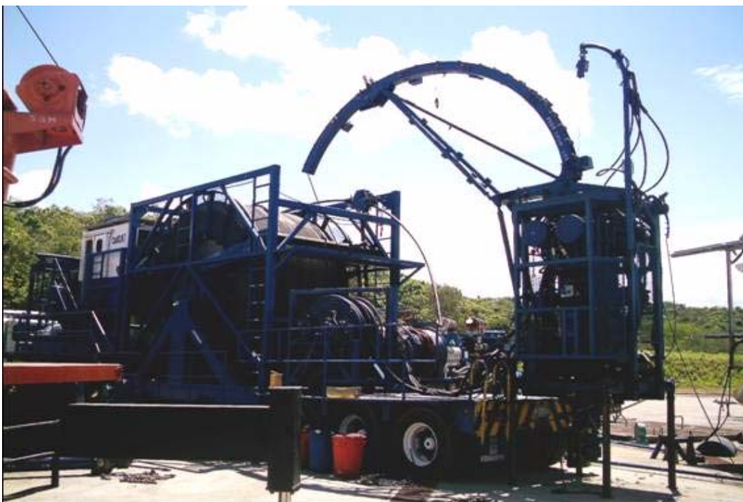
FIGURA 5. Unidad de CT en una intervención de pozo en el Campo Cusiana donde se observa el carrete, el arco guía y la cabeza inyectora.
