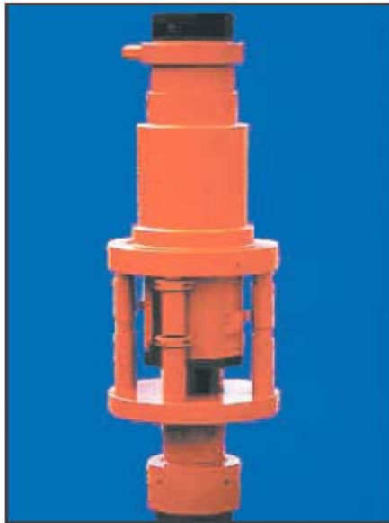
FIGURA 12. Stripper tipo ventana utilizado en los campos Cusiana-Cupiagua.
