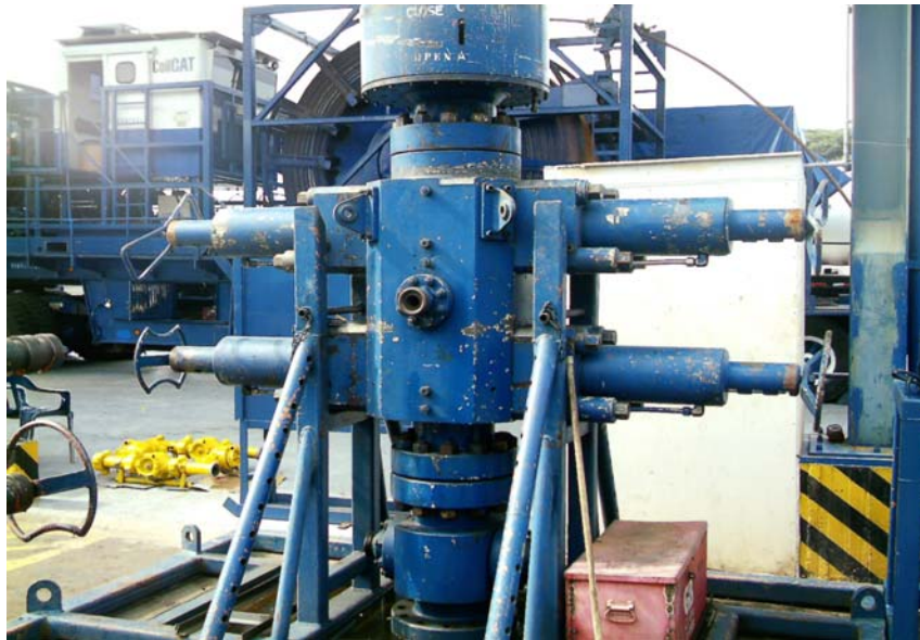
FIGURA 15. BOPs tipo COMBI utilizado en los campos Cusiana-Cupiagua.
