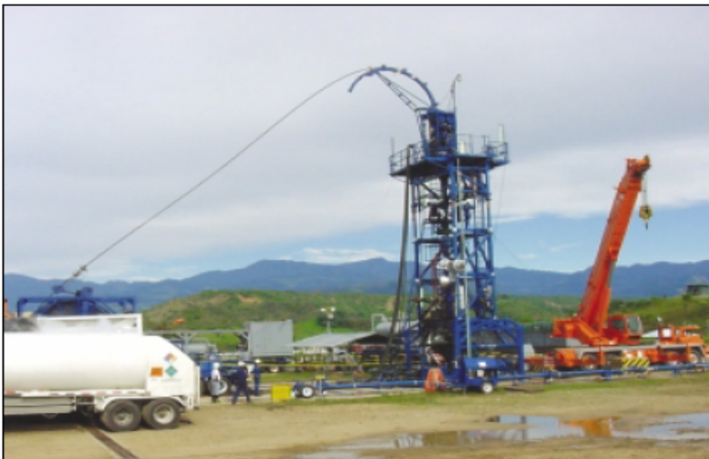
FIGURA 4. Unidad de CT en una intervención de pozo en el Campo Cusiana.
