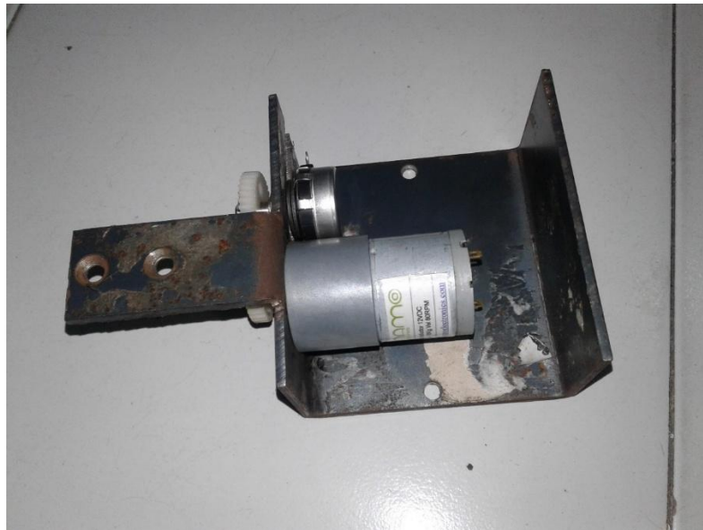
Figura 49. Chapa metálica soporte superior altura solar
