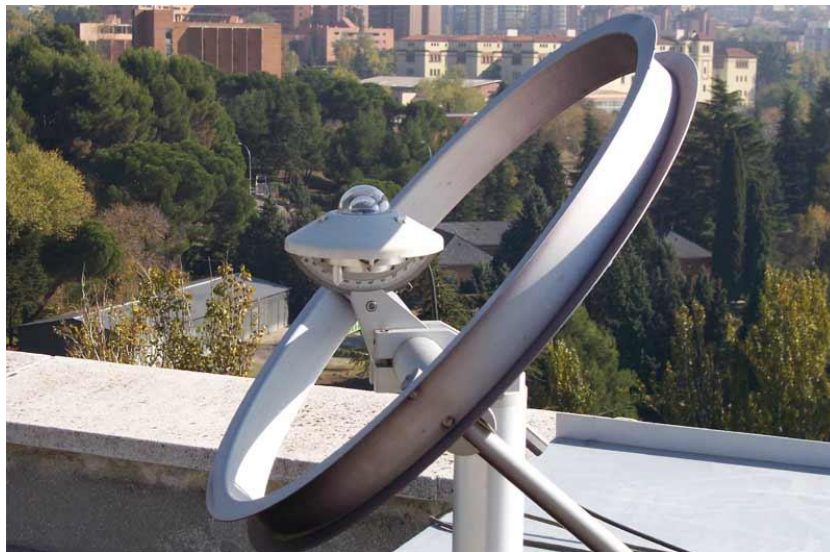
Figura 14. Piranómetro con anillo de sombra.
