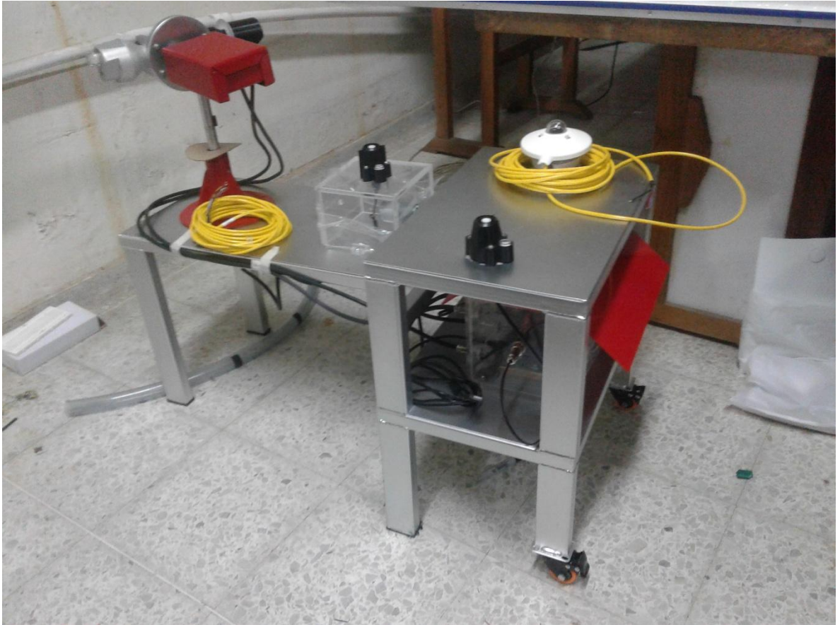
Figura 57. Montaje experimental para la comparación de sensores de radiación solar
