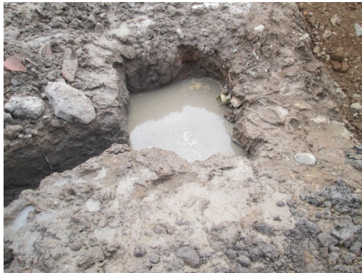
Figura 9. Evidencia de nivel freático.
