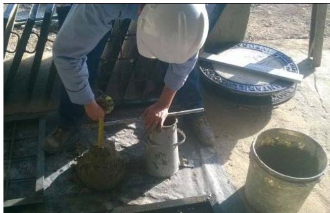
Figura 15. Realización del ensayo de Slump.
