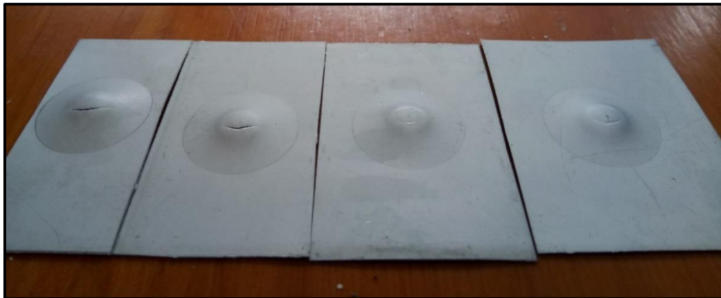
Figura 9. Morfología de las chapas de aluminio luego de la prueba de embutido.
