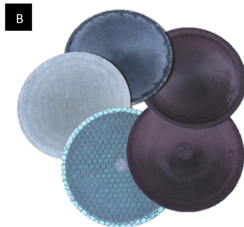
Figura 5. Discos (a) Desbaste grano fino-grueso, (b) Pulido.
