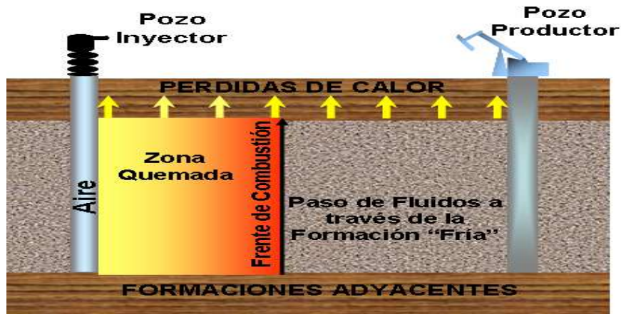
Figura 9. Esquema del Proceso de Combustión “in situ”
