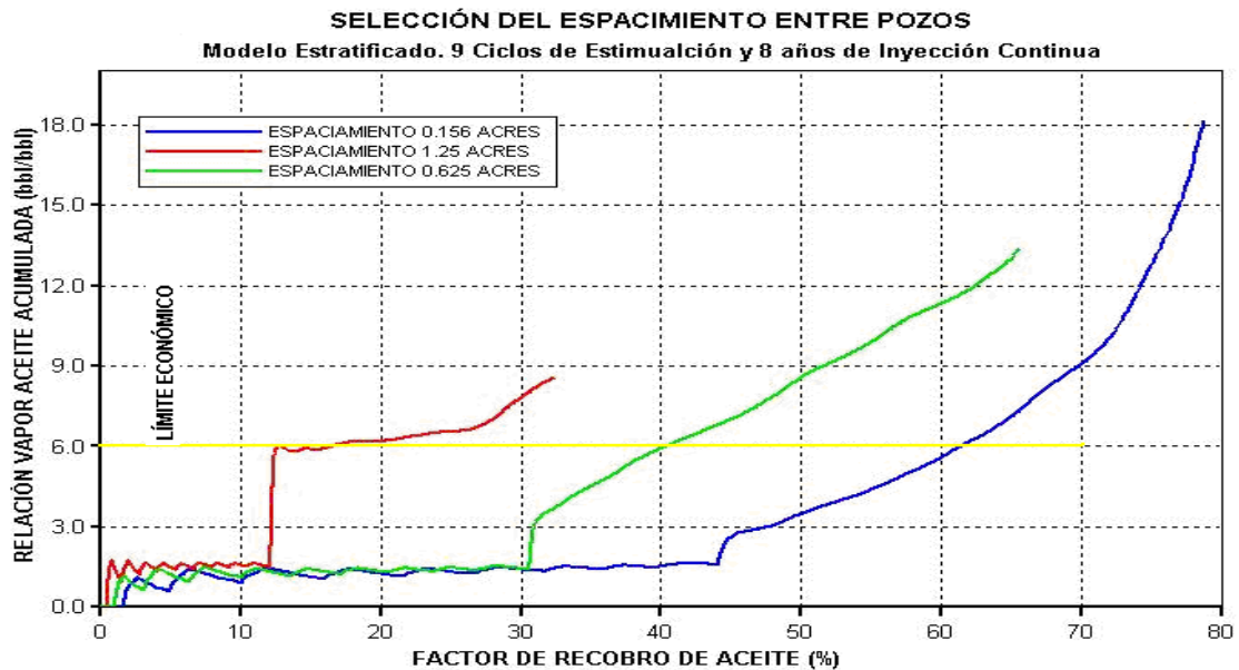
Figura 63. RAV vs Factor de recobro para diferentes espaciamientos en el proceso de inyección continua.
