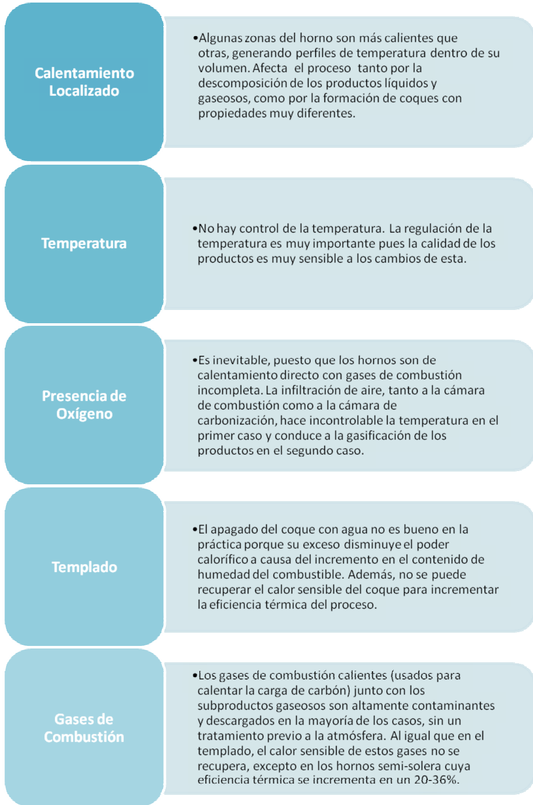
Figura 4. Desventajas del proceso actual de manufactura del coque en Colombia 19 .
