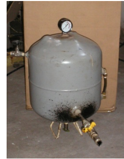
Figura 11. Tanque de separación.
