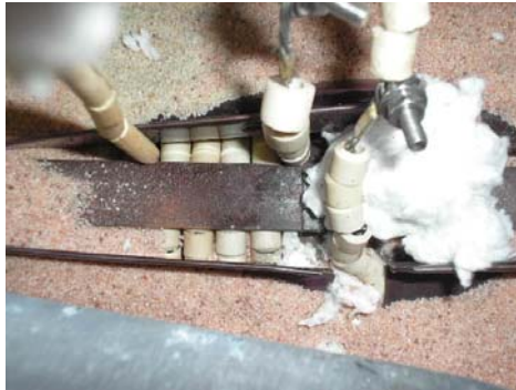
Figura 5. Detalle del montaje realizado a las resistencias de alambre.
