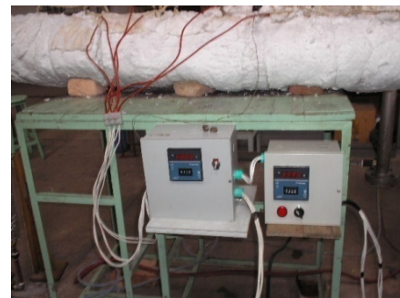
Figura 8. Sistema de Control.
