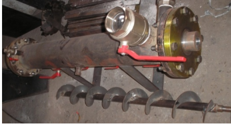
Figura 9. Reactor y su tornillo interno.
