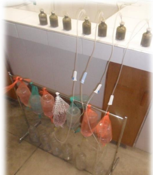
Medición biogás por desplazamiento
