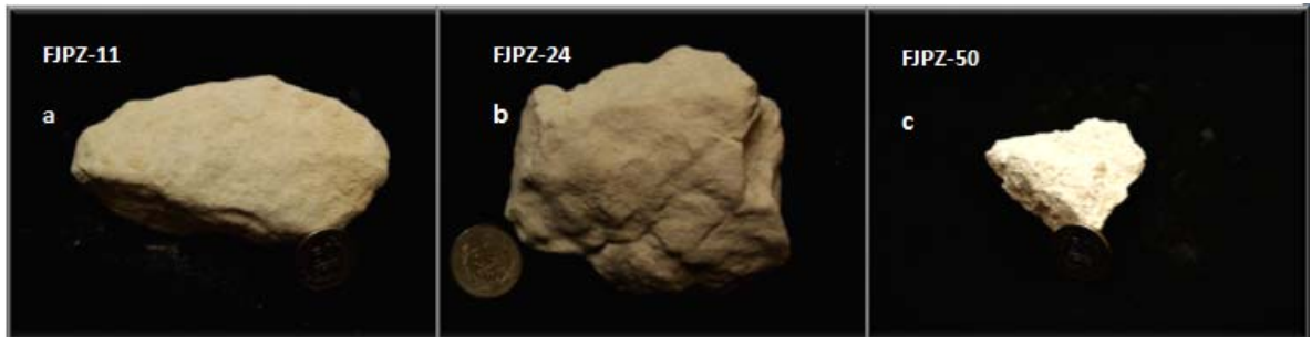
Figura 5. Muestra del material de partida a) fotografía de la muestra FJPZ-24 roca Subarcosa, b) muestra FJPZ-11 roca Subarcosa y c) muestra de roca FJPZ-50 roca Puzolana
