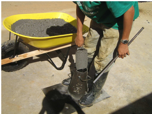
Figura 224. Colocacion de Capa de Concreto en Cono de Abrams.
