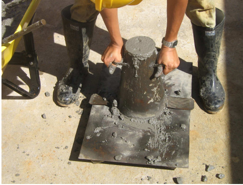
Figura 228. Posición Correcta y Tiempo de Espera para Retiro del Cono de Abrams.
