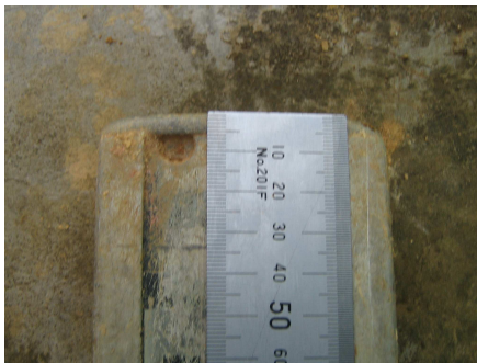
Figura 129. Verificación de la Mira: Uso de Regla Patrón.
