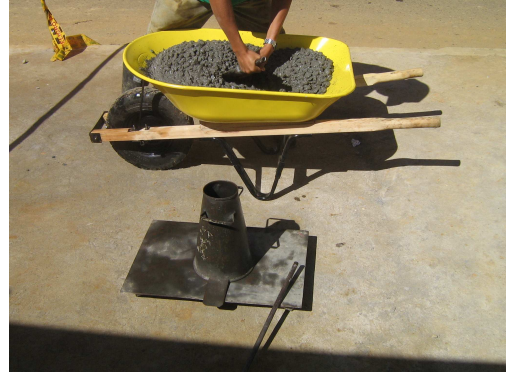
Figura 223. Mezcla Manual de Muestra de Concreto. Equipo de Ensayo de Asentamiento.
