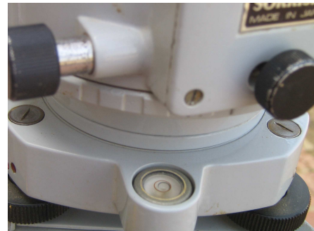
Figura 127. Ajuste del Teodolito: Centralización Equipo por segunda vez.
