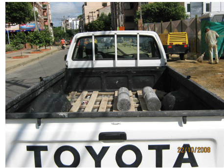
Figura 237. Traslado de Muestras de Concreto a Laboratorio para Ensayo a Compresión. Se utiliza Cama de Madera como Amortiguador.
