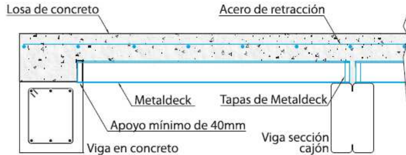
Figura 17. Esquema Típico de Apoyo de las Láminas de Steel Deck sobre la Viga.
