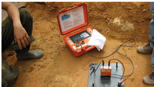
Figura 220. Funcionamiento del Densímetro Eléctrico. Procesamiento de información.
