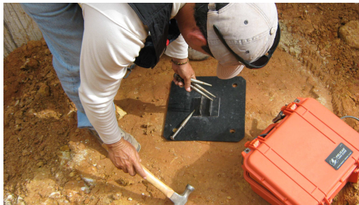
Figura 218. Instalación de la Base del Densímetro Eléctrico sobre el Suelo.
