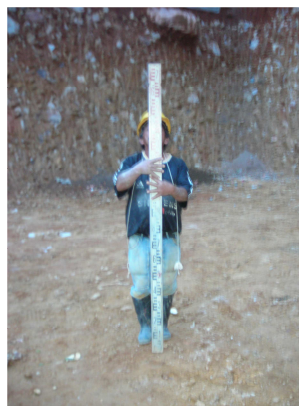
Figura 131. Ajuste de la Mira: Verticalidad.
