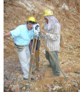
Figura 122. Verificación Teodolito: Cierre de poligonal.
