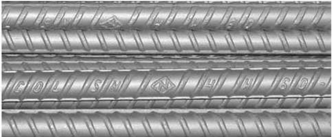
Figura 136. Demarcación e Identificación de Barras de Acero Estructural.
