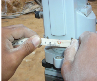
Figura 121. Verificación Teodolito: Cierre de poligonal.
