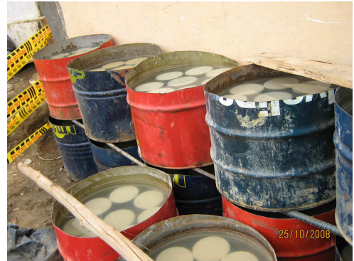
Figura 235. Curado de Muestras de Concreto.
