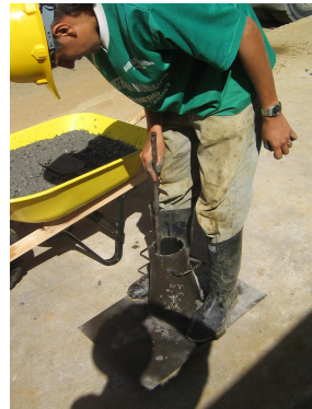
Figura 225. Vibrado de Capa de Concreto con Varilla Compactadora.
