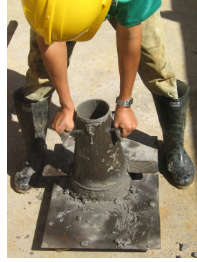
Figura 229. Retiro del Cono de Abrams de Forma Vertical Ascendente.
