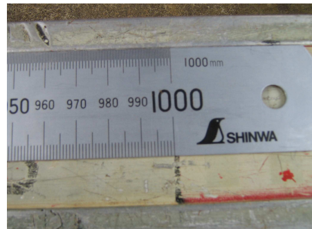
Figura 130. Verificación de la Mira: Uso de Regla Patrón.
