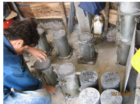
Figura 233. Desencofrado de Especímenes de Concreto.
