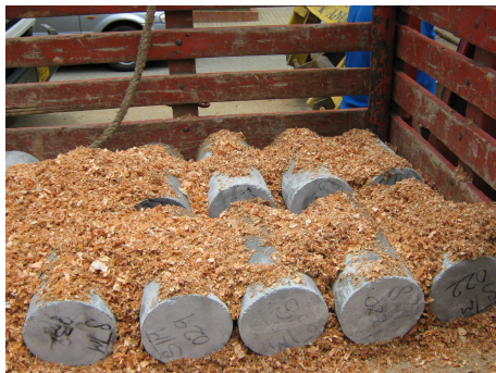
Figura 236. Traslado de Muestras de Concreto a Laboratorio para Ensayo a Compresión. Se utiliza Aserrín como Amortiguador.
