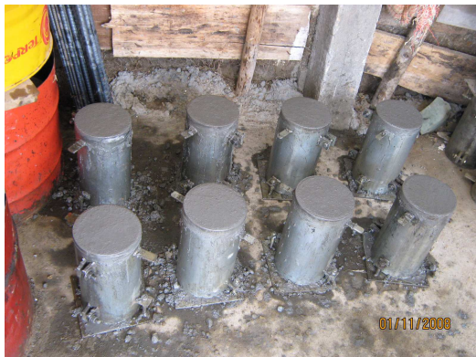
Figura 232. Elaboración de Probetas de Concreto usando Camisas Cilíndricas Metálicas.
