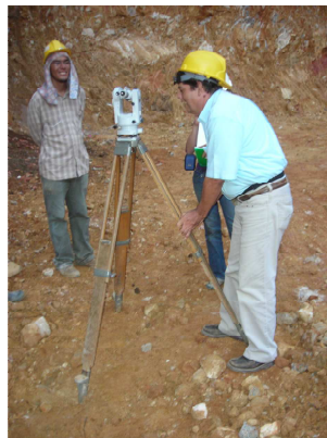
Figura 124. Ajuste del Teodolito: Centralización del Equipo.
