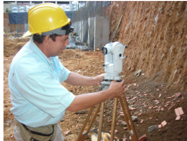
Figura 125. Ajuste del Teodolito: Nivelación del Equipo.
