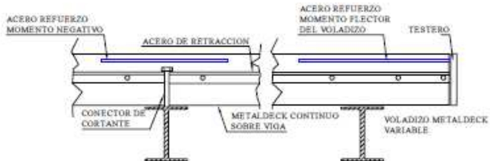
Figura 14. Detalle del Refuerzo Negativo en Voladizos.
