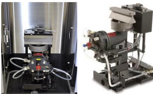
Fotografía 1. Montaje Técnica de Llama para Cu y Fe.
