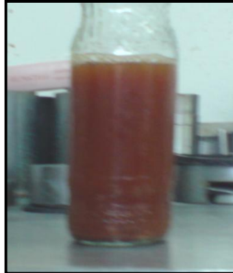
Figura 37 - Condición del tanino al final de prueba de refrigeración.
