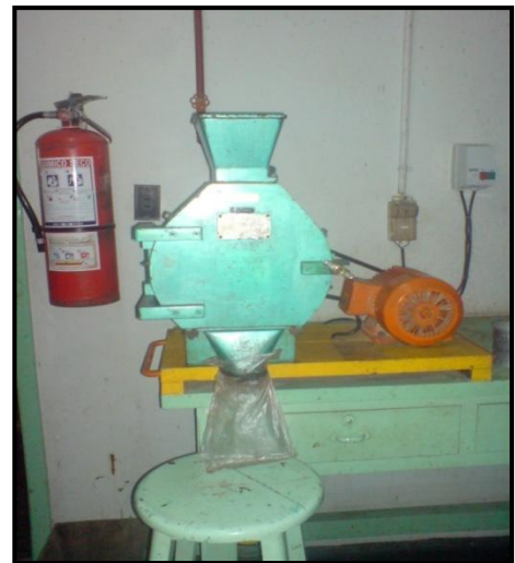
Figuras 18 y 19 - Molino de cuchillas STANDARD MODEL No 3 WILEY MILL. UIS
