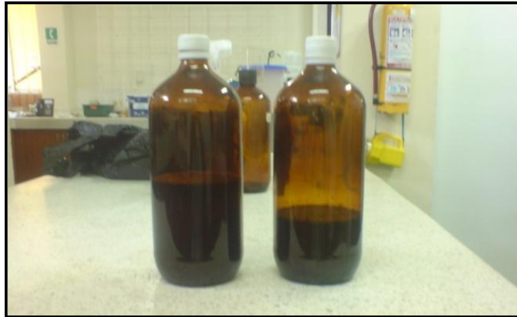
Figura 21 - Mezcla de corteza y acetona en frascos tapados.
