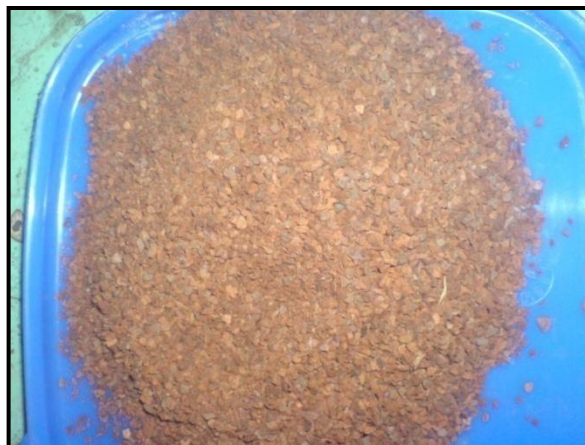
Figura 20 - Corteza molida en polvos gruesos por el molino de cuchillas.
