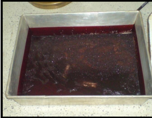
Figura 30 - Extracto tánico como polvo, adherido a las paredes del recipiente.
