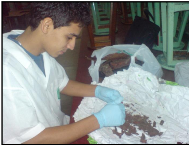
Figura 17 - Reducción de las cortezas hasta el tamaño que permite el molino.
