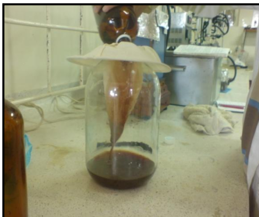
Figura 22 - Filtración de la corteza y obtención del 'jugo curtiente'.
