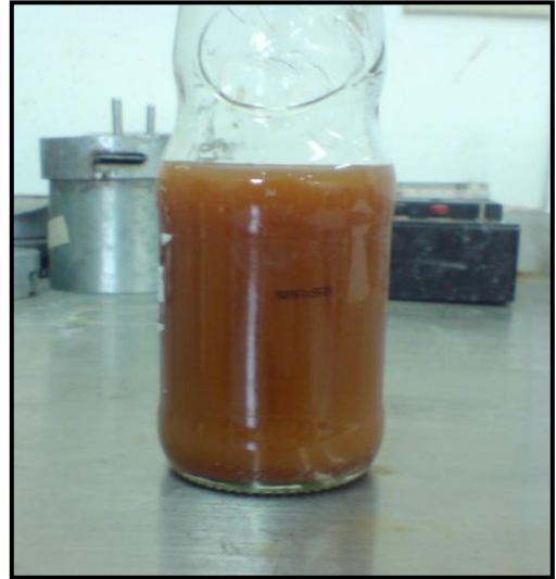
Figura 39 - Color de la solución tánica al final de prueba de refrigeración.
