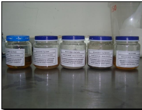
Figura 22. Prueba de compatibilidad para el almidón G 8060.
