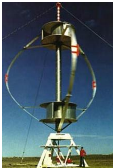
Figura 28. Diseño compuesto por rotor Darrieux y Savonius
