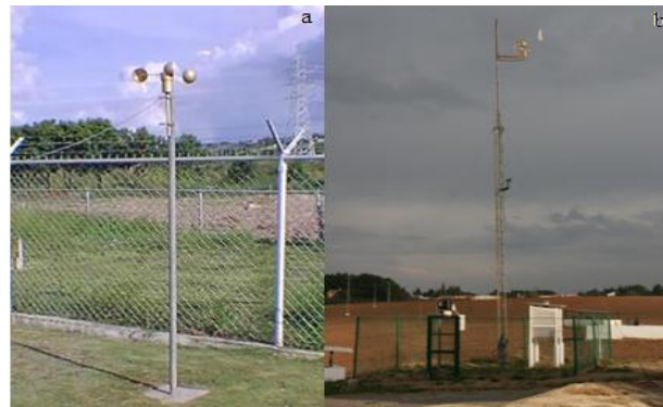
Figura 54. (a) Anemómetro de recorrido, (b) Estación especializada
