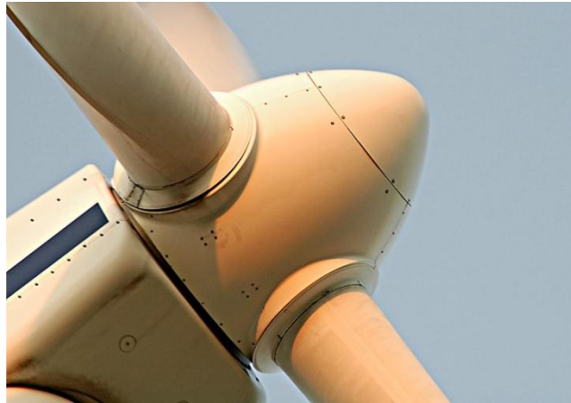
Figura 34. Rotor de un aerogenerador (palas + buje)
