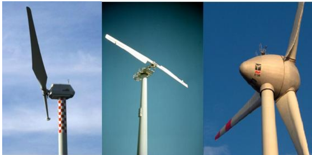
Figura 22. Aerogeneradores de eje horizontal de diferente numero de palas
