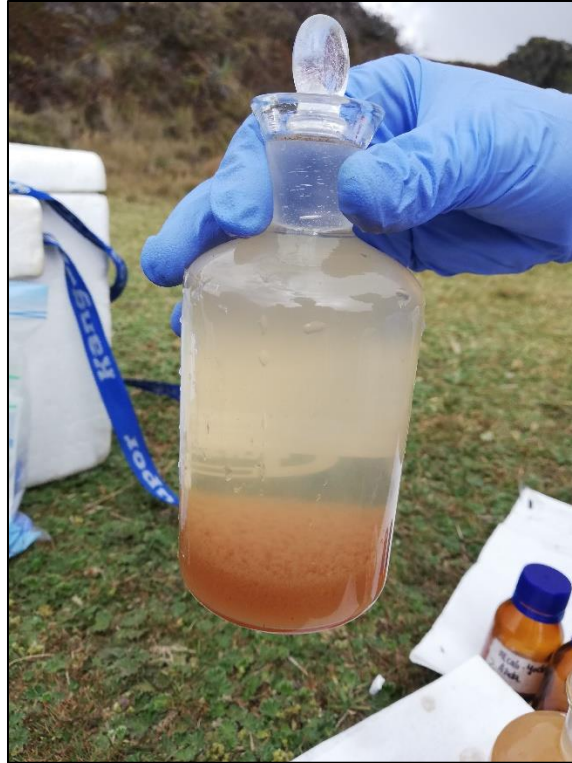
Figura F5 Adición de reactivos a muestras de laboratorio (oxígeno disuelto)
