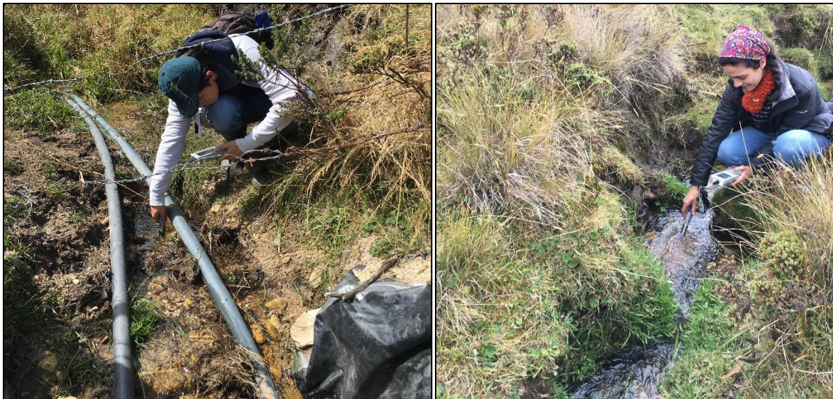
Figura F3. Medición de oxígeno disuelto
