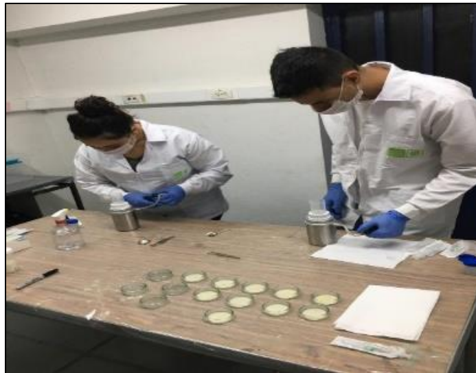
Figura F6 Análisis de E. coli mediante el método de filtración por membrana.
